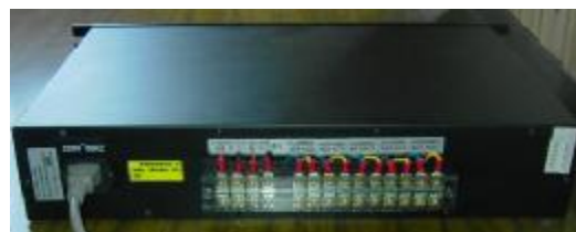
AC220/110V 输入，多组输出型后面板结构
